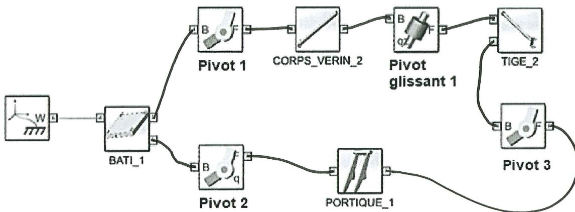
Figure B Modèle mécanique de la grue portique
