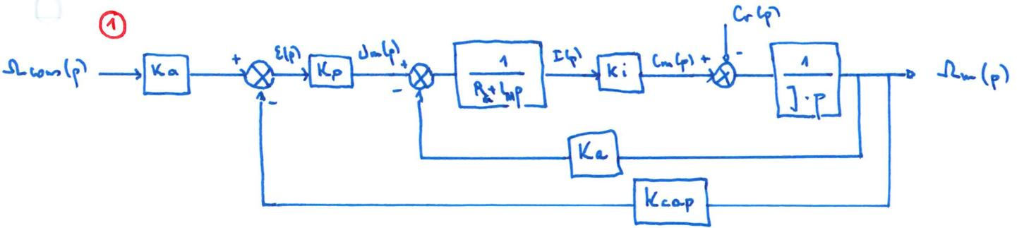
Pour que l'amortissement fonctionne, il faut  $\epsilon(p) = 0$  lorsque  $\Omega_m(p) = \Omega_{com}(p)$ .
