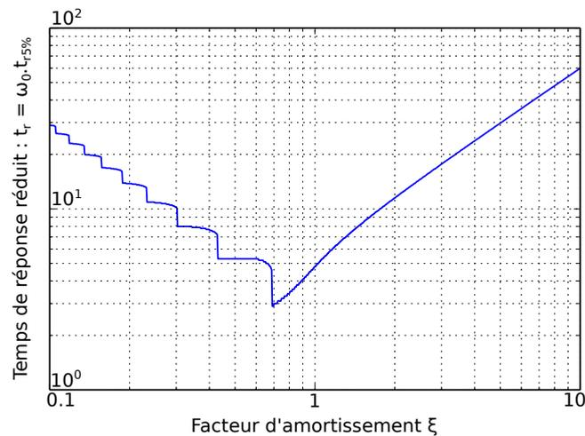
On remarquera que **le système est le plus rapide lorsque  $\xi = 0.7$** , dans ce cas il y aura alors des dépassements. Dans ce cas, on pourra se souvenir que le temps réduit vaut  $t_{red} = 3$ .
