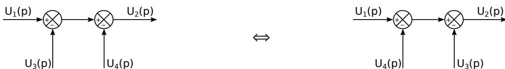
**Déplacement d'un sommateur (cas plus complexe) :** il est possible de permuter un sommateur et un bloc. Dans ce cas, il faut modifier le bloc lié au sommateur déplacé. Cette modification doit vérifier la forme initiale, c'est-à-dire qu'ici, on doit toujours conserver :  $U_2(p) = A(p).B(p).U_1(p) - E(p).B(p).U_3(p)$ .
