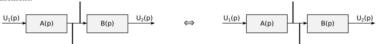
**Déplacement d'une jonction (cas plus complexe) :** il est possible de permuter un fil et un bloc. Dans ce cas, il faut modifier le bloc lié à la jonction déplacée. Cette modification doit vérifier la forme initiale, c'est-à-dire qu'ici, on doit toujours conserver :  $U_3(p) = A(p).C(p)$ .
