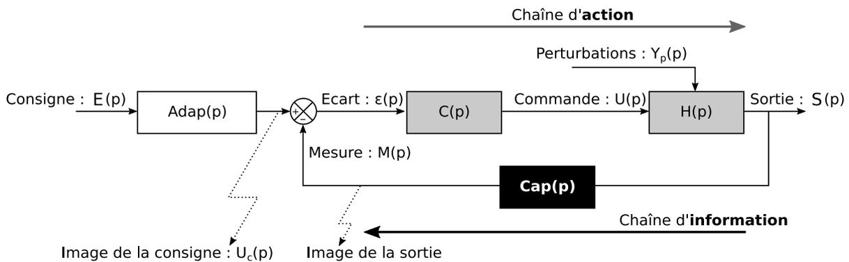
**Pourquoi faire les calculs dans le domaine symbolique de Laplace ?** La plupart des phénomènes observés peuvent se modéliser par des équations différentielles dont la variable est le temps  $t$ . On pourra par exemple lier une sortie  $s(t)$  à une entrée  $e(t)$  par une équation différentielle de la forme :
