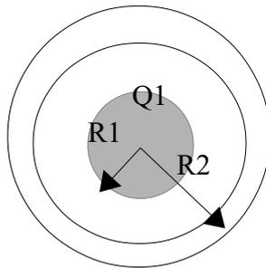
On considère un conducteur sphérique équipotentiel de rayon  $R_1$  et de potentiel  $V_1$ . Cette sphère est entourée d'un conducteur sphérique de rayon intérieur  $R_2$ , de faible épaisseur de potentiel  $V_2$ . L'espace entre les deux conducteurs est vide.
