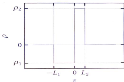
**Figure 7.16.** Représentation graphique de la densité volumique de charge  $\rho(z)$  en fonction de z pour la jonction comprise entre  $-L_1$  et  $L_2$ .
