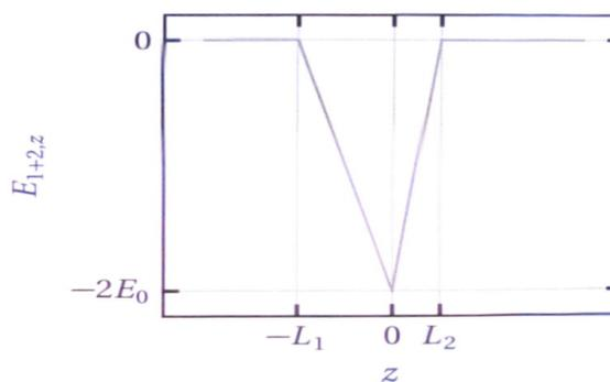
**Figure 7.17.** Évolution en fonction de z de la composante selon  $\vec{e}_z$  du champ électrostatique engendré par la jonction.
