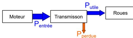
FIGURE 3 – Schématisation du transfert des puissances
