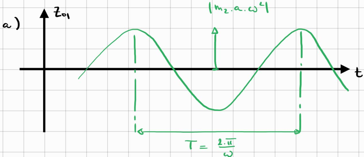
b) Il faut que  $\alpha = 0$ . Cela signifie que le centre de gravité du solide en rotation est situé sur l'axe de rotation.
