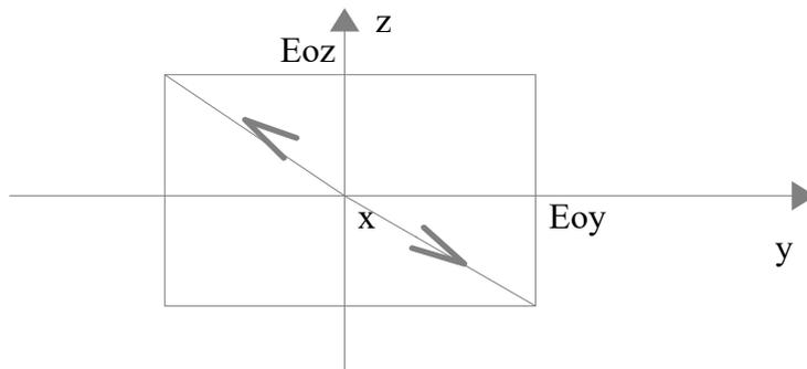
**Conclusion : si  $\phi_{0z} - \phi_{0y} = n\pi$  alors l'onde est polarisée rectilignement . Les champs électrique et magnétique gardent une direction fixe au cours de la propagation .**
