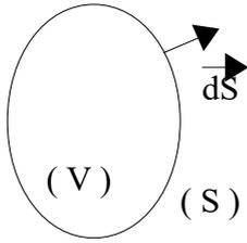
**L'équation de Maxwell-Thomson traduit le caractère conservatif du flux de  $\vec{B}$ .** Une des conséquence de cette conservation est que le flux de  $\vec{B}$  à travers une surface ouverte s'appuyant sur un contour fermé (C) ne dépend que de (C).
