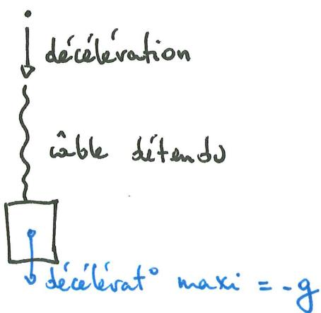
Si  $i$  est contrôlé, on contrôle alors  $C_m (= k \cdot i$  pour un moteur à courant continu). On contrôle donc également la décelération.
