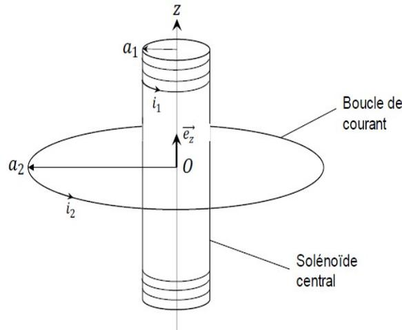
1- Exprimer l'inductance mutuelle  $M$  entre le solénoïde central et la boucle de courant, en fonction de  $i_2(t)$  et de  $a_1$ . Calculer  $M$  pour le tokamak ITER, sachant que  $a_1 = 2$  m et que le champ magnétique au centre du solénoïde est de 13 T pour un courant maximal de 46 kA.
