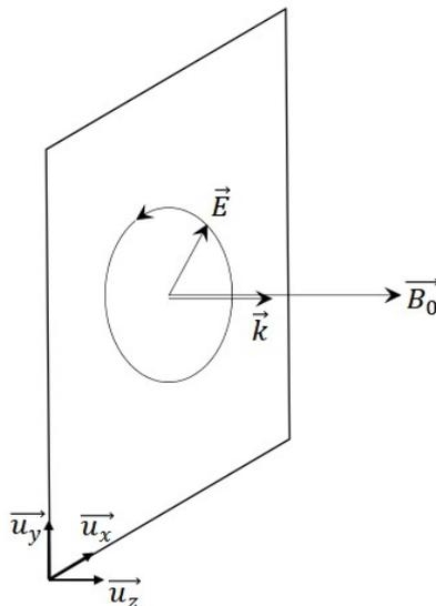
Onde de polarisation circulaire gauche se propageant parallèlement au champ magnétique  $\vec{B}_0$
