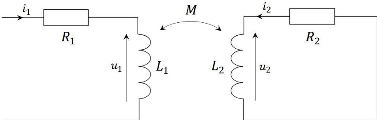
2- Montrer que  $i_2(t)$  vérifie l'équation différentielle :  $\frac{d i_2}{d t} + \frac{i_2}{\tau_2} = \frac{I_0}{\tau_1}$  avec  $\tau_1$  et  $\tau_2$  qui seront exprimés en fonction de  $L_2, R_2, M$  et de  $t_1$ .
