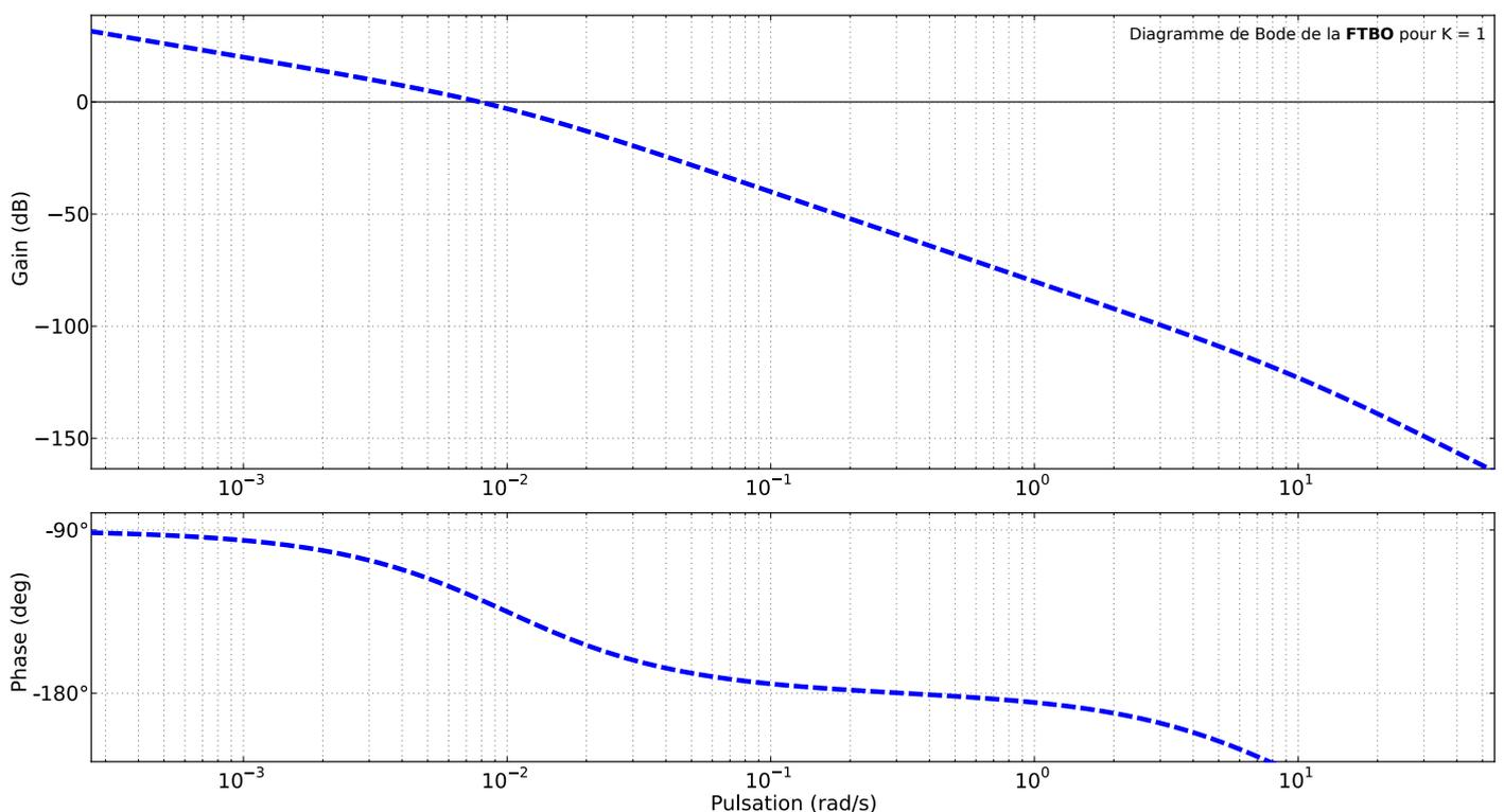
On souhaite ici que le système possède une marge de gain de 10 dB et une marge de phase de 45°.
