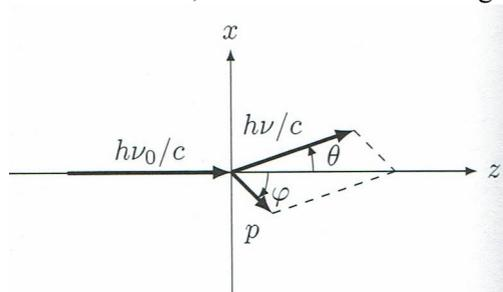
L'objectif est d'établir, puis de discuter le décalage entre longueur d'onde du photon incident  $\lambda_0$  et longueur d'onde du photon diffusé  $\lambda$ , pour un angle  $\theta$  donné:
