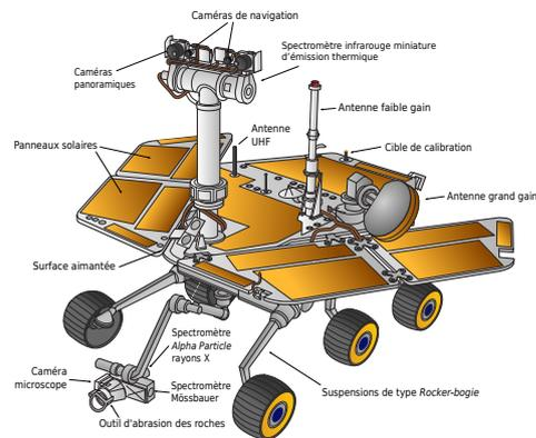
Deux caméras panoramiques implantées sur une tête périscopique permettent au robot de s'orienter et de repérer la cible à analyser. Le mouvement du robot est actionné par 6 moteurs électriques asservis, lui permettant de se positionner devant la cible.
