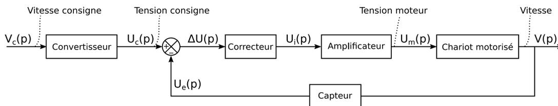
Le chariot est actionné par un moteur électrique piloté par sa tension d'entrée  $u_m$ . Cette tension est obtenue à l'aide d'un amplificateur fournissant une tension  $u_m$  proportionnelle à la tension  $u_i$
