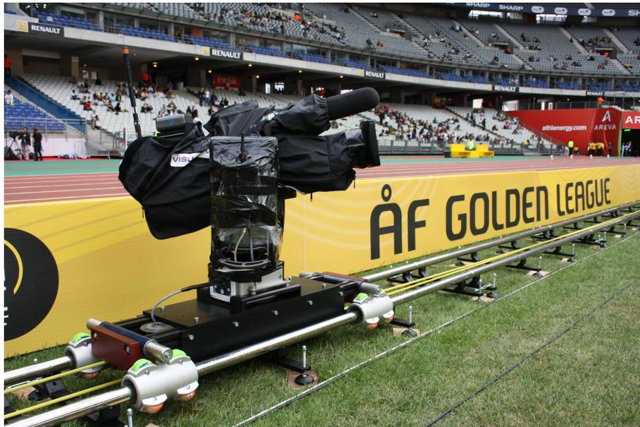
Un capteur optique permet de mesurer la position de la caméra par rapport au coureur. Un ordinateur détermine la consigne de vitesse nécessaire pour suivre le coureur, transmise sous forme de tension de commande à l'asservissement du chariot. Le chariot est asservi en vitesse comme le montre le schéma fonctionnel présenté sur la figure ci-dessous. Il doit satisfaire aux exigences suivantes :
