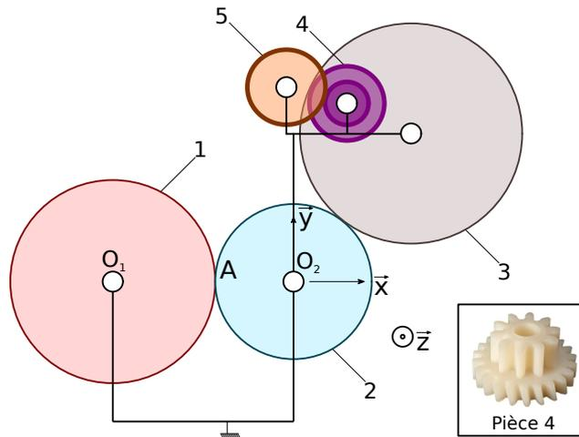
On note maintenant :  $R_1$ , le rayon de la roue 1,  $R_2$ , le rayon de la roue 2,  $R_3$ , le rayon de la roue 3,  $R_{43}$  le rayon de la partie de la roue 4 qui engrène avec la roue 3,  $R_{45}$  le rayon de la partie de la roue 4 qui engrène avec la roue 5, et  $R_5$ , le rayon de la roue 5.
