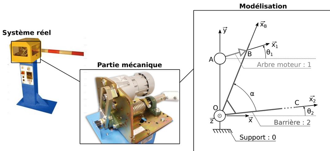
On paramètre le mécanisme de la manière suivante :
