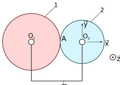
On considère le cas d'un engrenage à deux roues dentées 1 et 2 qui roulent sans glisser en A. On note  $R_1$ , le rayon de la roue dentée 1 et  $R_2$ , le rayon de la roue dentée 2. On note  $\vec{\Omega}_{1/0} = \omega_{10} \cdot \vec{z}$  et  $\vec{\Omega}_{2/0} = \omega_{20} \cdot \vec{z}$ .
