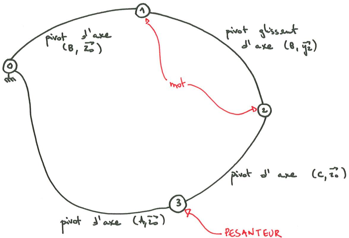
① J'isole  $\{1, 2\}$  soumis aux actions mécaniques extérieures suivantes:
