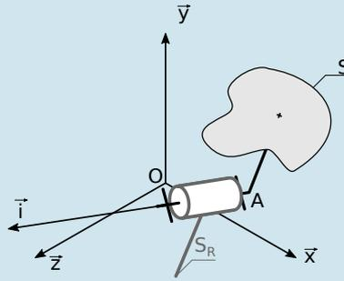
Pour une liaison pivot d'axe  $(A, \vec{i})$  avec frottement, où il y a :
