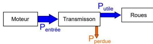
FIGURE 4 – Schématisation du transfert des puissances
