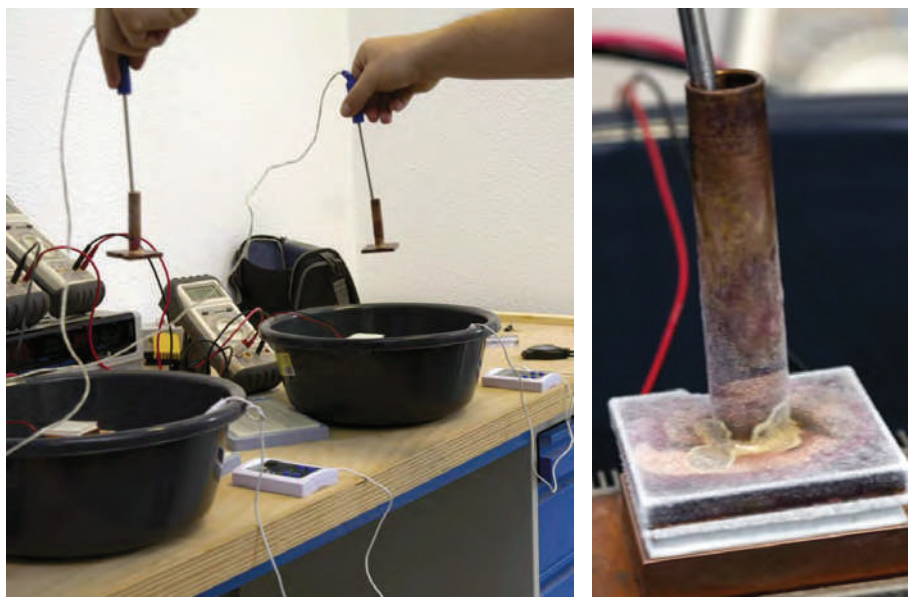
Figure 12 - Les éprouvettes givrent pendant l'expérience, l'eau est congelée.
