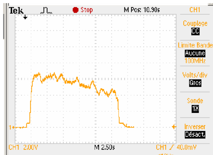
Graphique 12: Allure de la vitesse d'une roue alu vidée freinée (mesure 2)
