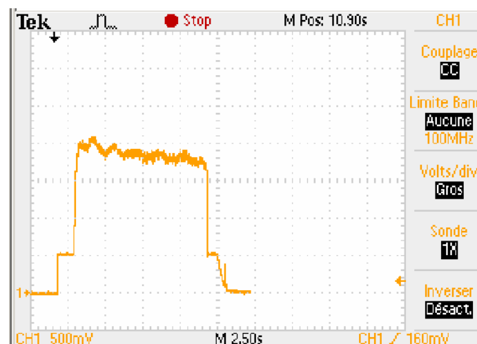
Graphique 45: Allure de la vitesse d'une roue alu vidée freinée (mesure 2)
