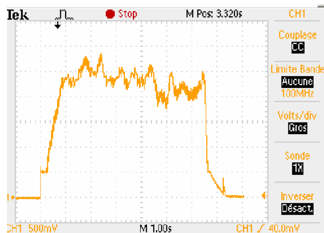
Graphique 20: Allure de la vitesse d'une roue alu vidée freinée (mesure 2)
