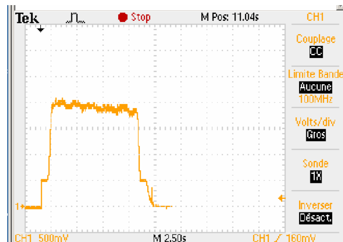
Graphique 44: Allure de la vitesse d'une roue alu vidée freinée (mesure 1)
