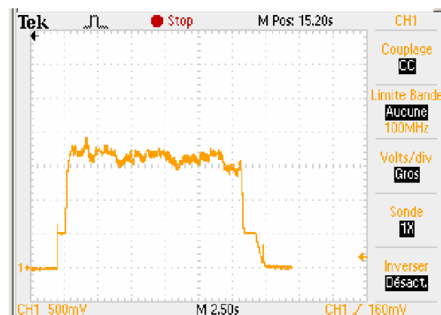
Graphique 27: Allure de la vitesse d'une roue laiton freinée (mesure 2)
