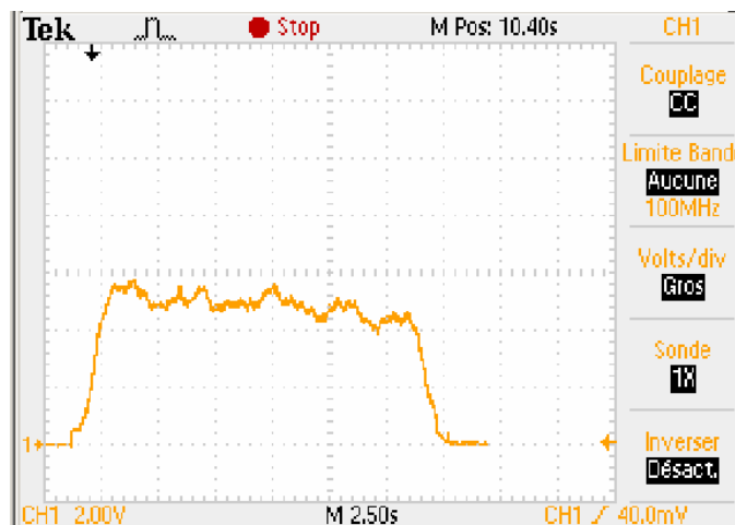
Graphique 14: Allure de la vitesse d'une roue laiton freinée (mesure 2)
