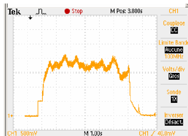
Graphique 21: Allure de la vitesse d'une roue laiton freinée (mesure 1)
