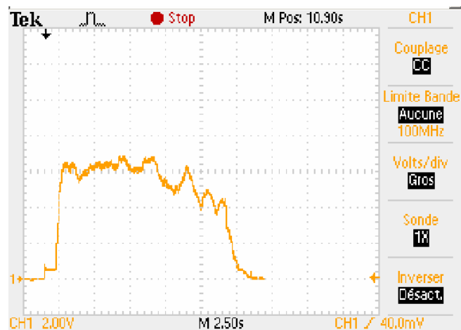
Graphique 11: Allure de la vitesse d'une roue alu vidée freinée (mesure 1)
