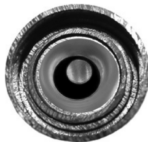
Vue de l'aimant qui chute dans le tuyau en cuivre en donnant l'impression d'être freiné par un parachute invisible.
