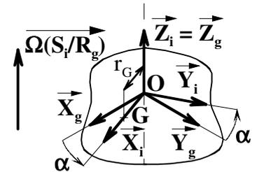
☞  $\overrightarrow{\Omega}(S_i/R_g)$  le vecteur rotation du solide  $S_i$  par rapport au repère  $R_g$  :  $\overrightarrow{\Omega}(S_i/R_g) = \dot{\alpha} \cdot \vec{Z}_g = \omega \cdot \vec{Z}_g$
