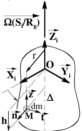
Sachant que le moment dynamique en  $O$  est défini par :  $\delta_{O(S_i/R_g)} = \iiint_{S_i} \overrightarrow{OM} \wedge \overrightarrow{a_{M \in S_i/R_g}} \cdot dm$
