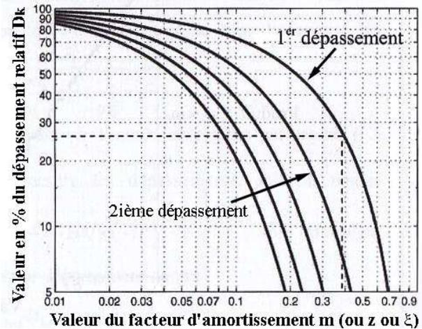
☞ A l'aide de la valeur de  $\xi$  et de l'abaque ci-contre on détermine le temps réponse réduit :  $t_{5\%} \cdot \omega_0$
