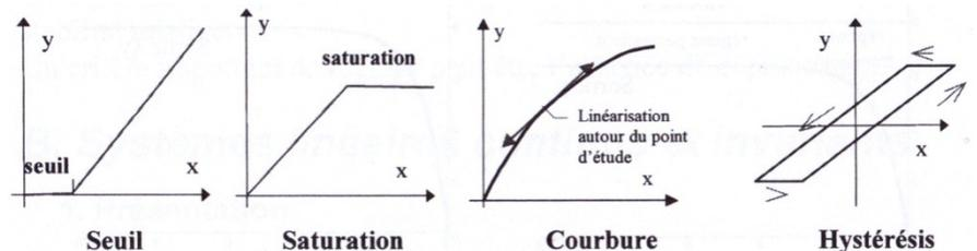
L'effet de saturation est notamment du aux butées mécaniques du système ou à celles des interfaces de puissances : Saturation des amplificateurs opérationnels ou des hacheurs (MLI ou PWM)
