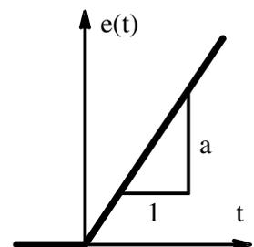
Ce type d'identification est intéressant pour identifier des systèmes dont le comportement est proche de celui d'un système du 1<sup>ier</sup> ordre dont la forme des fonctions de transferts est :  $H(p) = \frac{K}{1 + \tau.p}$
