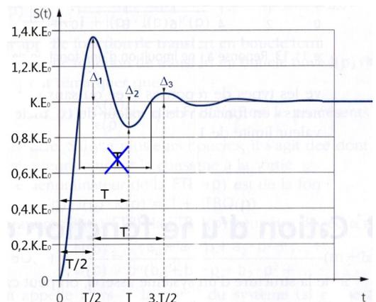
**Méthode de détermination analytique des caractéristiques  $\xi$ ,  $\omega$  et  $\omega_0$  du système :**
