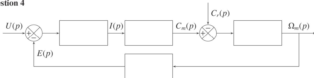
DR1 – Schéma-bloc des moteurs de propulsion
