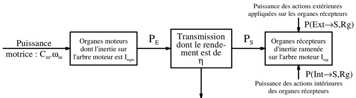
La transmission a un rendement  $\eta$ . Par définition ce rendement est le rapport entre les puissances à l'entrée de la transmission et celle à la sortie de la transmission.
