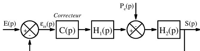
La Fonction de Transfert en Boucle Ouverte : **FTBO** est la fonction de transfert de la sortie du comparateur au retour à ce même comparateur. Ici : **FTBO(p) =  $\frac{S(p)}{\epsilon(p)}$** . Ici :  $C(p).H_1(p).H_2(p)$ .
