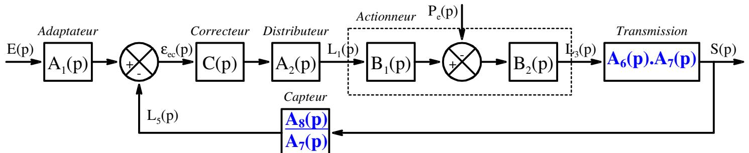
En général, la boucle de retour est un gain pur :  $\frac{A_8(p)}{A_7(p)} = C^{\text{te}}$ . Et on a un fonctionnement normale de
