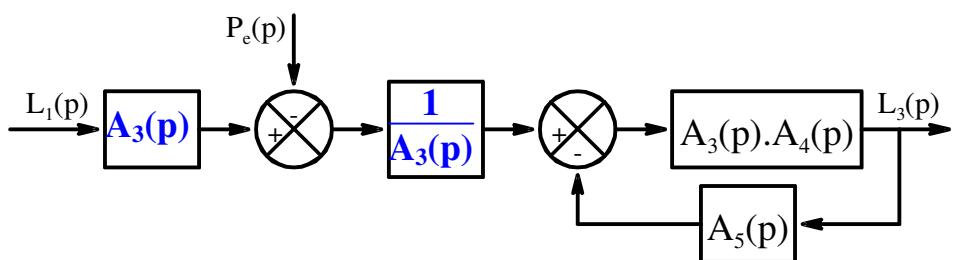
On obtient donc :  $B_1(p) = A_3(p)$  et :  $B_2(p) = \frac{A_4(p)}{1 + A_3(p).A_4(p).A_5(p)}$
