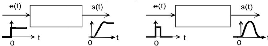
Etudier la réponse libre d'un système, revient à écarter le système de sa position d'équilibre (Par exemple par une entrée de type impulsion et à analyser sa réponse. Ce système est :
