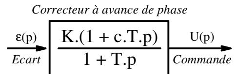
**5.2- Correction électronique analogique (Exemple)**
