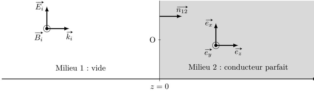
FIGURE 2 – Onde électromagnétique en incidence normale sur un conducteur parfait.
