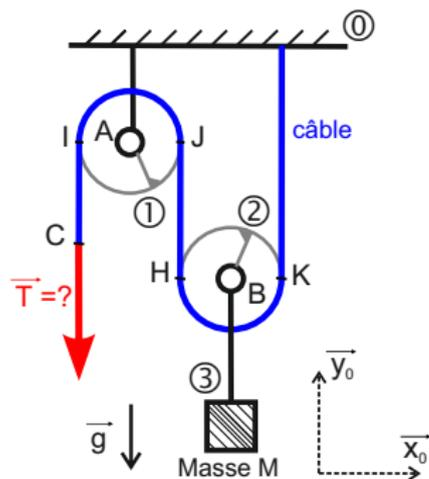
**Déterminer** la tension  $T$  à appliquer sur le câble, en fonction de la charge  $M$ , afin de maintenir le système à l'équilibre dans  $\mathcal{R}_0$  galiléen.
