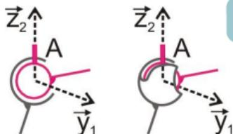
**Sphérique à doigt de centre A d'axe  $(A, \vec{z}_2)$ , de normale  $\vec{y}_1$**
