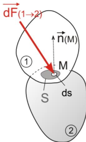
Torseur d'action mécanique surfacique de contact en O :
