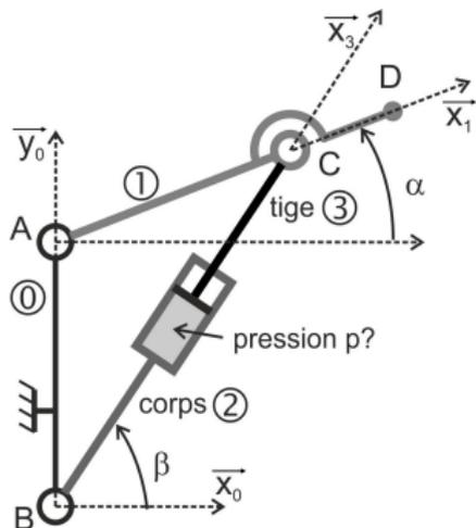
**Déterminer** la pression  $p$  dans le vérin (de section  $S$ ) en fonction de l'effort  $F$  exercé en  $D$  sur  $1$  et des données géométriques, afin de maintenir le système à l'équilibre dans  $\mathcal{R}_0$  galiléen.
