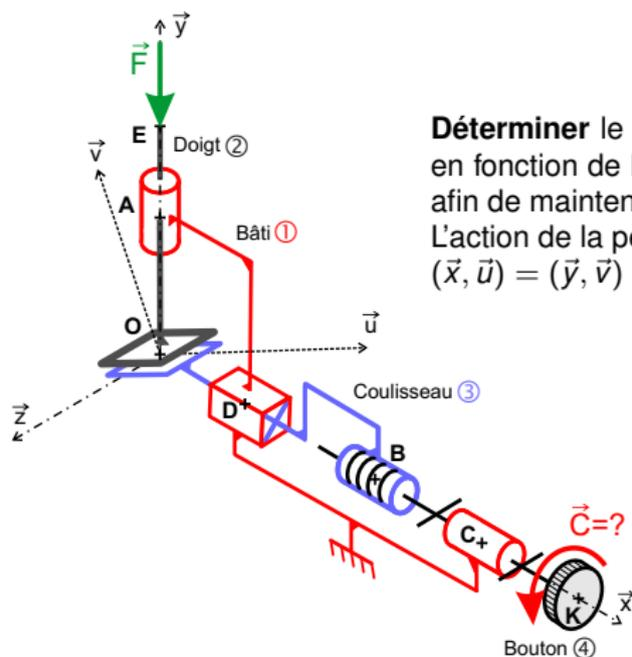
**Déterminer** le couple  $C.\vec{x}$  à fournir au bouton de manoeuvre 4 en fonction de l'effort extérieur  $F$  et des données géométriques, afin de maintenir le système à l'équilibre dans  $\mathcal{R}_1$  galiléen.
