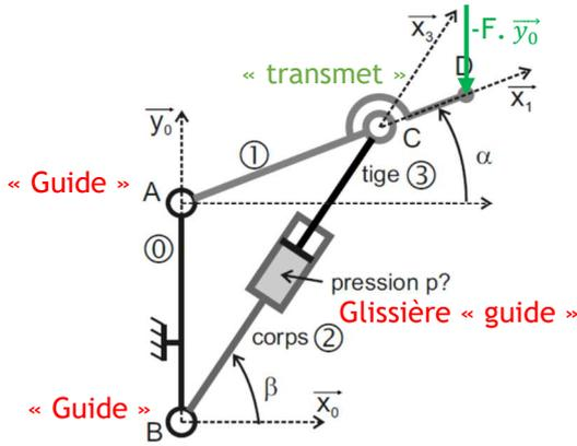
**Déterminer** la pression  $p$  dans le vérin en fonction de l'effort  $F$  exercé en D sur 1 et des données géométriques, afin de maintenir le système à l'équilibre dans  $\mathcal{R}_0$  galiléen.
