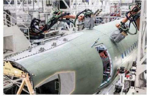
Figure 1 : cellules robotisées pour l'assemblage de structures d'avion
