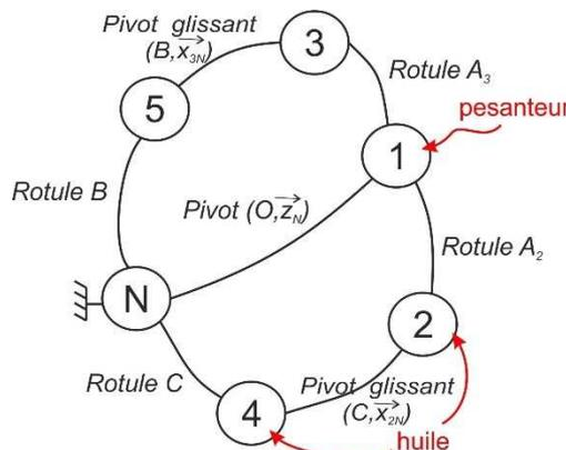
**Q2 - En précisant le système isolé, montrer que l'action de 2 sur 1 en  $A_2$  est représentable par le glisseur dont la forme sera notée :**  $\{T_{2 \rightarrow 1}\} = \begin{Bmatrix} F_{21} \cdot \vec{x}_2 \\ \vec{0} \end{Bmatrix}_{A_2}$  ou  $\begin{Bmatrix} F_{21} \cdot \vec{x}_N \\ \vec{0} \end{Bmatrix}_{A_2}$  puisque  $B_N = B_2$ .
