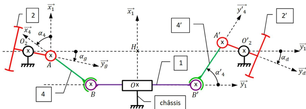
Figure 1 : schéma cinématique de la direction
