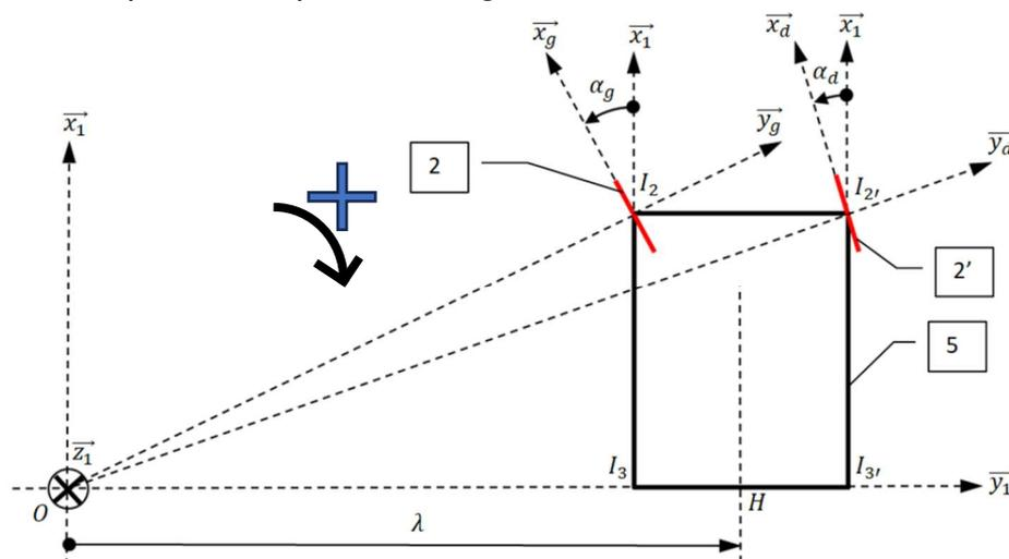
Figure 3 : modèle mécanique pour un virage vers la gauche
