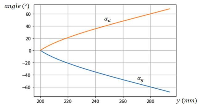
**Figure 2 :** évolution des angles  $\alpha_d$  et  $\alpha_g$  en fonction du déplacement de la crémaillère  $y$
