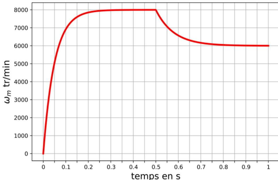
Un moteur à courant continu est alimenté par une tension  $u_m(t)$  d'amplitude  $u_0 = 6V$ , un couple résistant  $c_r(t)$  de type échelon d'amplitude  $c_{r0} = 0,007N.m$  est appliqué à l'instant  $t = 0,5s$ .
