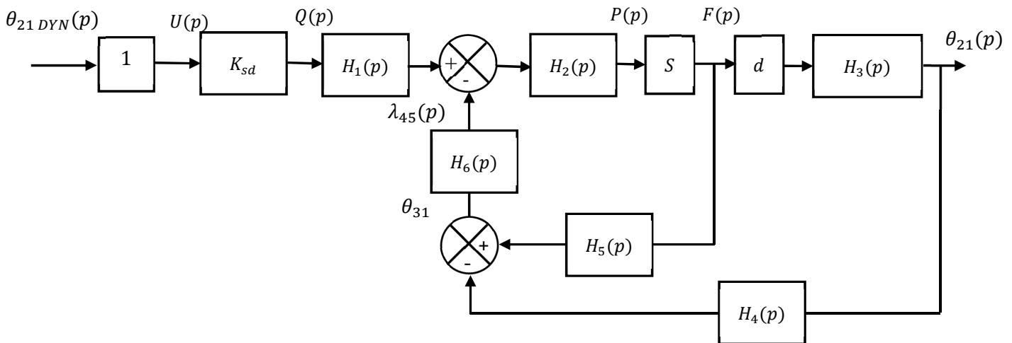
**Question :** Déterminer la fonction de transfert de la boucle dynamique  $F_{DYN}(p) = \frac{\theta_{21}(p)}{U(p)}$  en fonction des fonctions de transfert ( $K_{sd}, H_1, H_2, H_3, H_4, H_5$  et  $H_6$ ) des paramètres ( $S$  et  $d$ ) .
