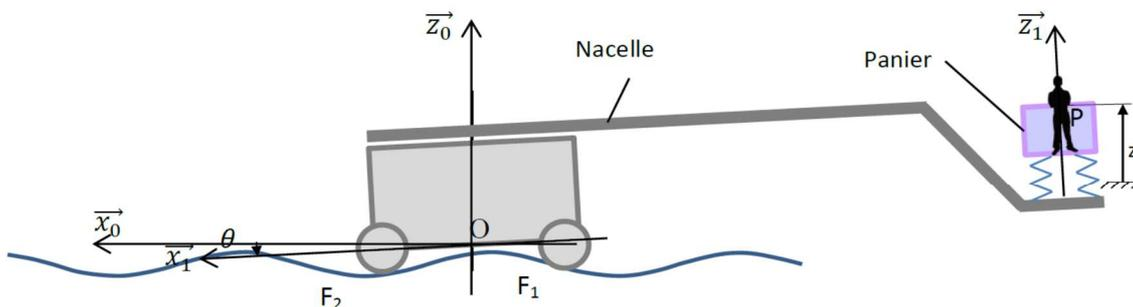
Figure 7 : Modèle simplifié sur terrain accidenté
