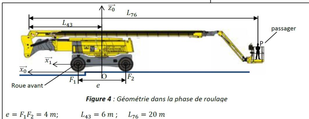
Figure 4 : Géométrie dans la phase de roulage
