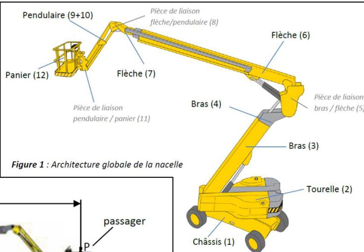
Figure 1 : Architecture globale de la nacelle
