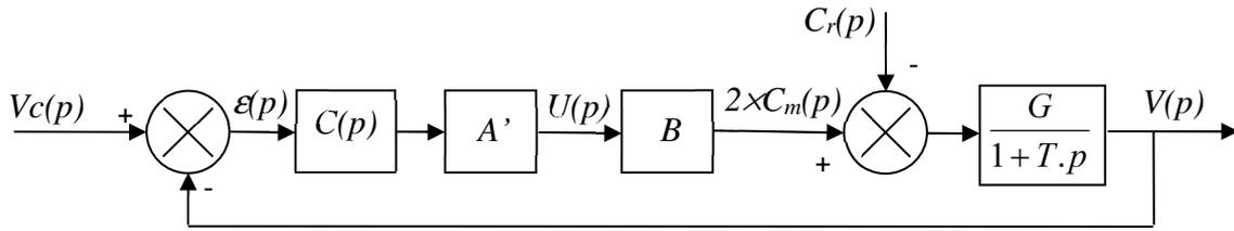
Les coefficients  $E$  et  $F$  sont intégrés dans les nouveaux coefficients  $A'$  et  $G$ . Pour la suite, on continuera avec les valeurs suivantes :  $A'.B = 3 \times 10^4 \text{ s.N}$  ;  $G = 6 \times 10^{-5} \text{ m}/(\text{s.N.m})$  et  $T = 0.47 \text{ s}$ .
