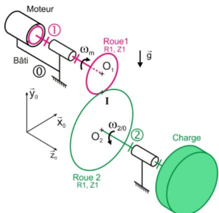
(1) = {Arbre 1, Roue 1, rotor moteur}
