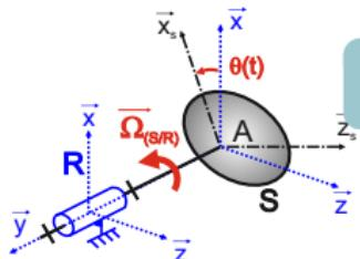
Solide en rotation autour d'un axe fixe passant par A,  $\vec{V}_{(A,S/R)} = \vec{0}$
