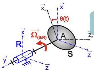
Solide en rotation autour d'un axe fixe passant par  $A$ ,  $\vec{V}_{(A,S/R)} = \vec{0}$
