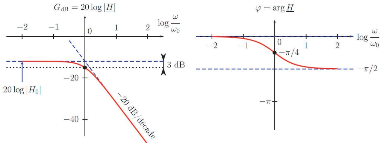
FIGURE 1 – Diagramme de Bode du filtre RC.
