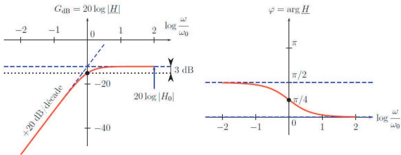
FIGURE 2 – Diagramme de Bode du filtre CR.
