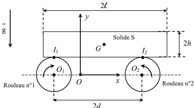
**Vue dans le plan vertical ( $Oxy$ ) à un instant  $t > 0$ . Les flèches rondes indiquent le sens de rotation des rouleaux.**
