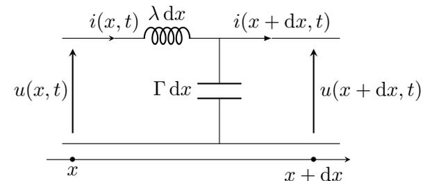
À l'instant  $t$ , on note  $u(x, t)$  et  $u(x + dx, t)$  les tensions aux abscisses  $x$  et  $x + dx$ . De même, les intensités dans le fil "du dessus" sont notées  $i(x, t)$  à l'abscisse  $x$  et  $i(x + dx, t)$  en  $x + dx$ .
