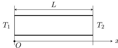
Le régime stationnaire est réalisé et la température dans le barreau ne dépend que de  $x$ .
