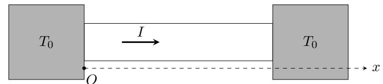
Le résistor est parcouru par un courant électrique d'intensité constante  $I$ . On se place en régime stationnaire et on suppose que la température dans le cylindre ne dépend que de  $x$ .
