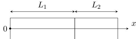
a) Faire un schéma électrocinétique équivalent pour cet ensemble et en déduire la température  $T_i$  à la jonction des deux barres en fonction de  $T_1$ ,  $T_2$ ,  $L_1$ ,  $L_2$ ,  $\lambda_1$  et  $\lambda_2$ .
