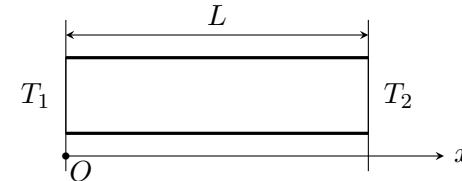
Le régime stationnaire est réalisé et la température dans le barreau ne dépend que de  $x$ .
