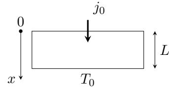
1. On impose en  $x = 0$  une densité de courant thermique  $j_Q(0) = j_0$  tandis qu'en  $x = L$ , une source de chaleur (thermostat) maintient la température à la valeur constante  $T_0$ . Déterminer  $T(x)$  en fonction de  $j_0$ ,  $\lambda$ ,  $T_0$  et  $L$ .
