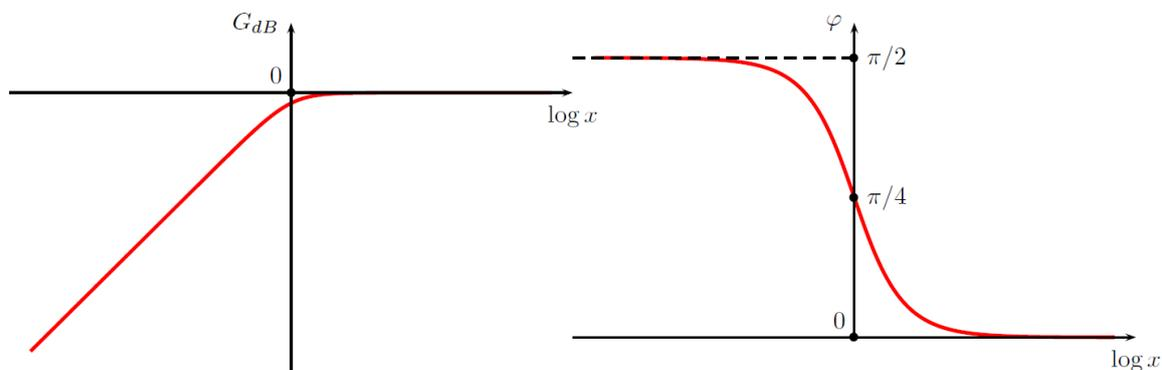
FIGURE 1 – Diagramme de BODE du filtre ( $F_a$ )
