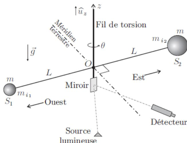
FIGURE 1 – Dispositif d'Eötvös.
