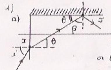
Pour que la propagation soit guidée, il faut qu'il y ait une réflexion totale en J, donc que :  $\beta > \beta_{\text{lim}} = \arcsin\left(\frac{n_2}{n_1}\right)$  or  $\theta = \frac{\pi}{2} - \beta$  donc cela revient à  $\theta < \frac{\pi}{2} - \arcsin\left(\frac{n_2}{n_1}\right)$
