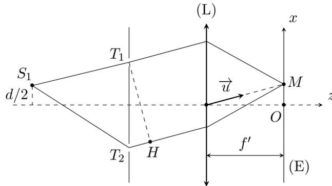
b) Plaçons une source ponctuelle en  $M$  et utilisons le principe du retour inverse de la lumière. Tous les rayons lumineux issus de  $M$  et qui traversent la lentille (en sens inverse) ressortent parallèles entre eux. D'après le théorème de Malus, les surfaces d'onde associées sont des morceaux de plan perpendiculaires à ces rayons. Sur le schéma, le plan d'onde qui passe par  $T_1$  permet de définir sur le rayon passant par  $T_2$  le point  $H$ . Nous avons donc :
