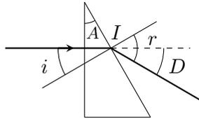
L'angle d'incidence par rapport à la normal vaut  $i$  et l'angle de réfraction vaut  $r$ . La loi de Snell - Descartes donne alors :
