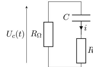
Soit  $u_1$  la tension aux bornes du condensateur idéal. Une loi des mailles conduit à :
