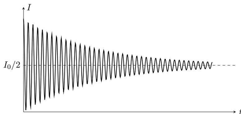
5) a) On mesure la période  $T$  sur la seconde figure :  $12T = 4$  donc  $T = 333$  ms. Sur la première figure, on remarque que, partant de 1 pour l'enveloppe supérieure, on arrive à 0,59 au bout de 400 s. On en déduit que :
