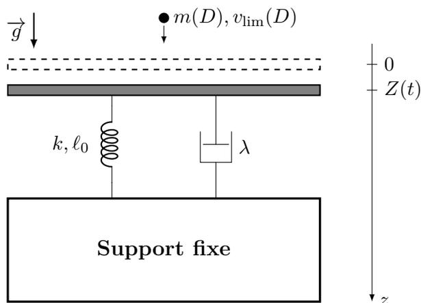
FIGURE 7 – Modélisation du disdromètre à impact à platine.
