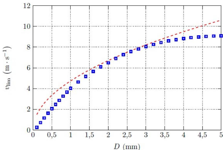
FIGURE 5 – Influence du diamètre des gouttes sur la vitesse limite.
